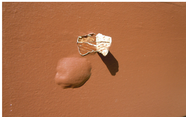
Figura 2: Ampollas hasta recubrimientos o sustratos anteriores.
